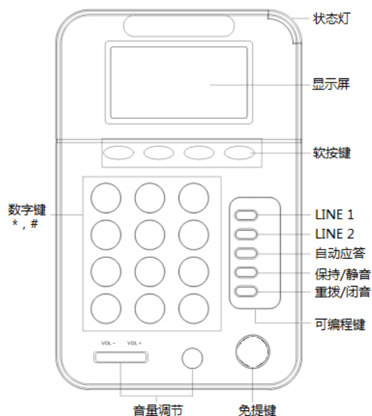
图 3.1 SayHi CC800v2 IP 话务盒正面图
